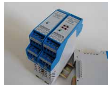
EFB-EK4 mit Schaltnetzteil ENT-Bus
